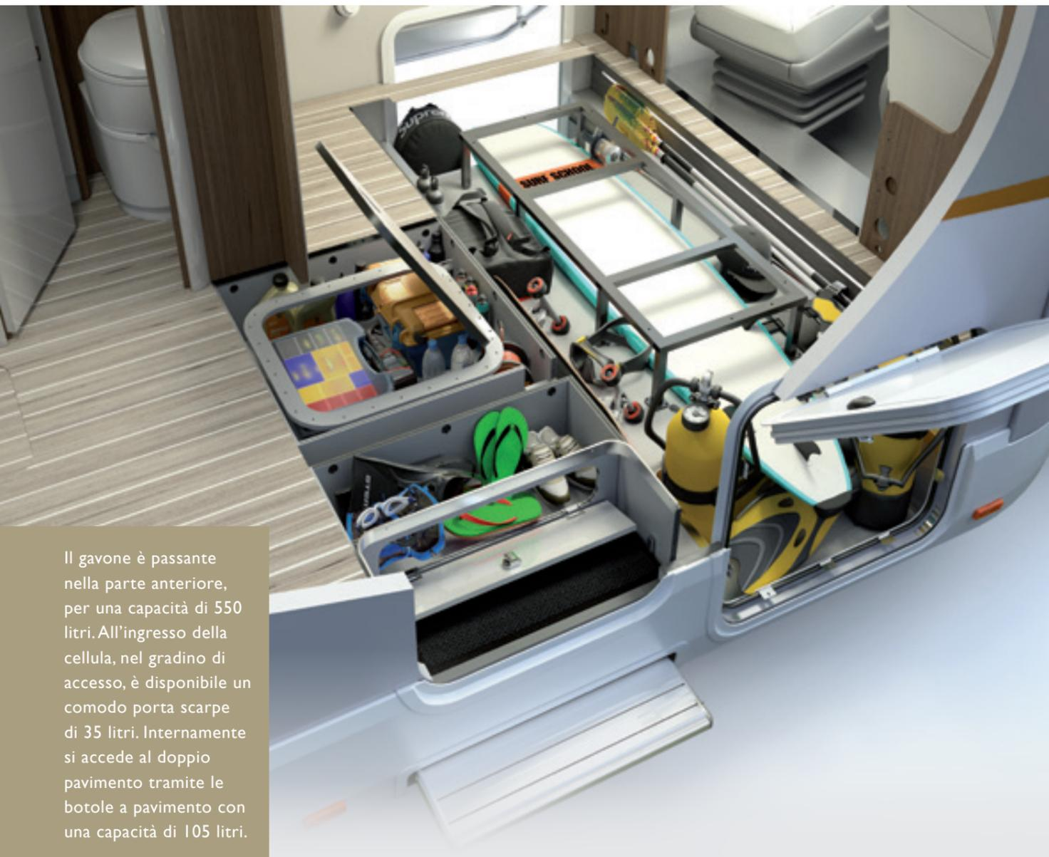
Il gavone è passante nella parte anteriore, per una capacità di 550 litri. All'ingresso della cellula, nel gradino di accesso, è disponibile un comodo porta scarpe di 35 litri. Internamente si accede al doppio pavimento tramite le botole a pavimento con una capacità di 105 litri.
